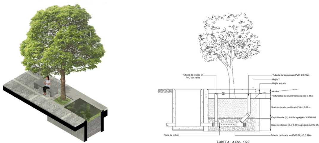
Figura 32. Detalle alcorque inundable SUDS.
