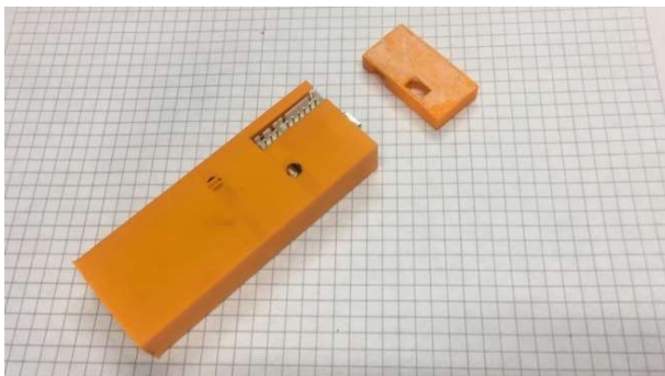
Ilustración 13, Carcasa interna de protección impresa
