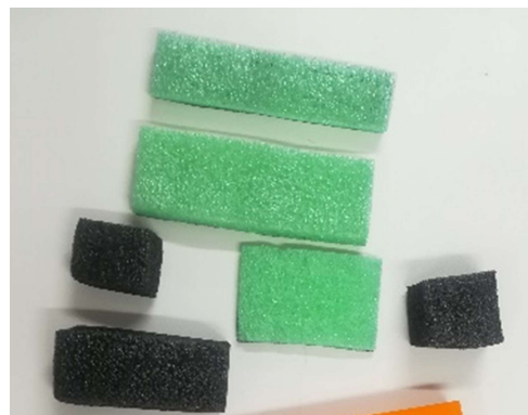
Ilustración 14, Espumas de protección térmica y sujeción interna
