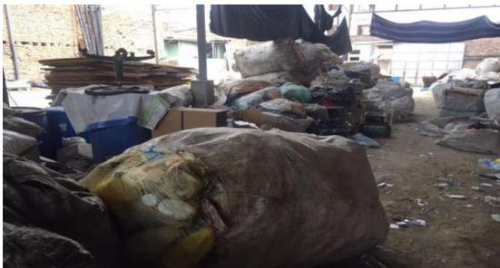
*Se observa en la imagen que no hay vías de circulación despejadas, no hay distribución de material de acuerdo a su tipo y el piso irregular pone en riesgo a recicladores de sufrir caídas a nivel.*
