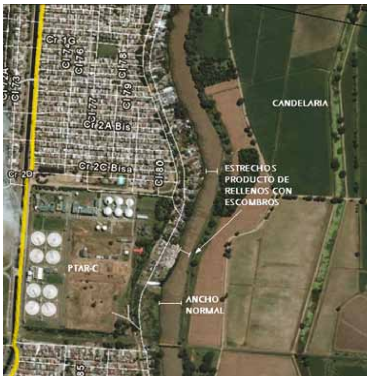
Río Cauca, problema de relleno con escombros sobre el jarillón para la ubicación de asentamientos urbanos. Sector posterior a la PTAR - C
