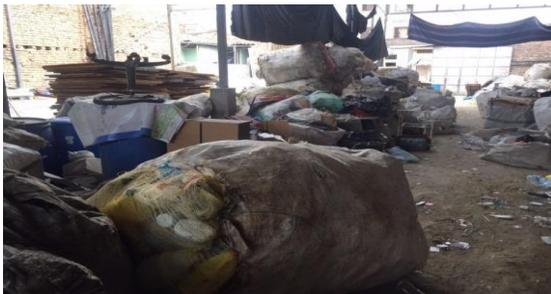
*Se observa en la imagen que no hay vías de circulación despejadas, no hay distribución de material de acuerdo a su tipo y el piso irregular pone en riesgo a recicladores de sufrir caídas a nivel.*
