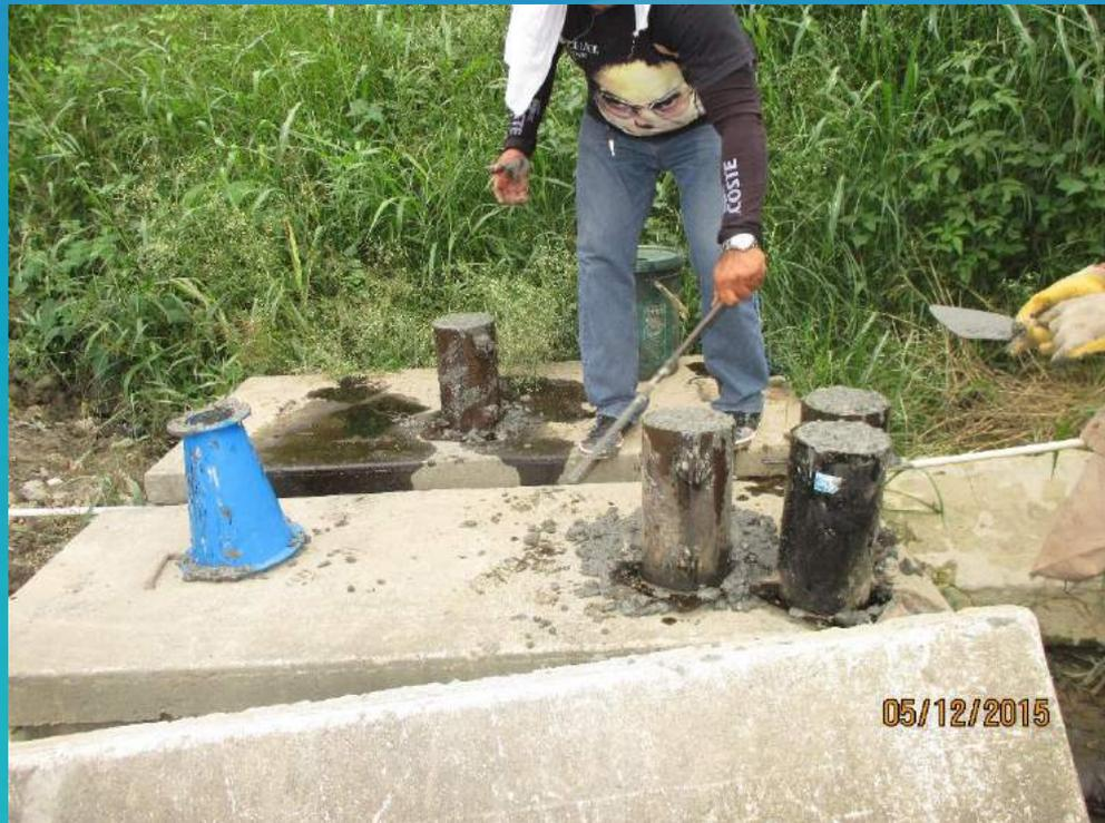
Toma de muestras de cilindros de concreto para ensayos de laboratorio.
