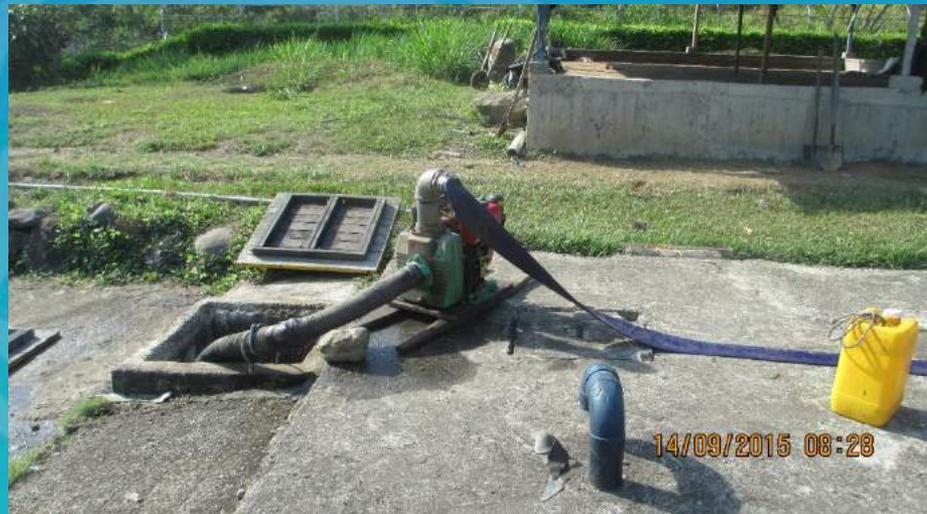
Bombeo de lodos de filtro anaeróbico
